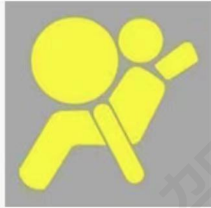
安全气囊处于故障状态
